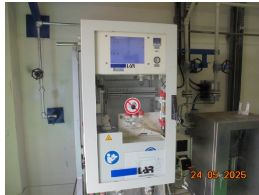
รูปที่ 3.2-21 ระบบตรวจวัดค่า COD แบบอัตโนมัติ
