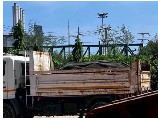
รูปที่ 3.1-2 การปิดคลุมและผูกมัดวัสดุและอุปกรณ์ก่อสร้างระหว่างการขนส่ง
